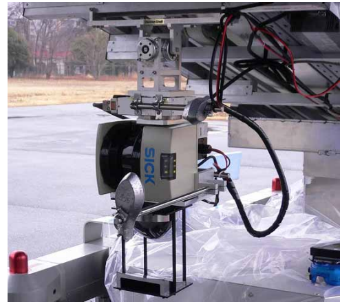
Fig. 6 親機搭載用吊り下げ型三次元距離センサユニット
