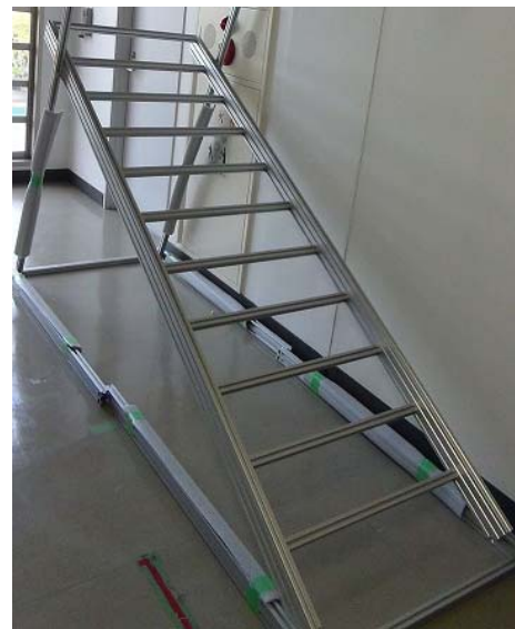
図 5 可変式階段模擬試験装置
