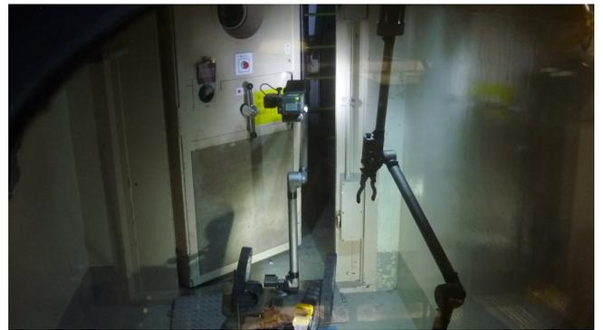
Fig. 1: 福島第一原子力発電所内部でのpacbotによるドア開け作業の様子(©東京電力)
