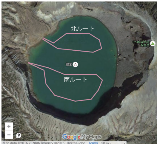
図 5. Google MyMaps 上で設定した USV の目標パス (従来の調査用のロープを避けて設定)
