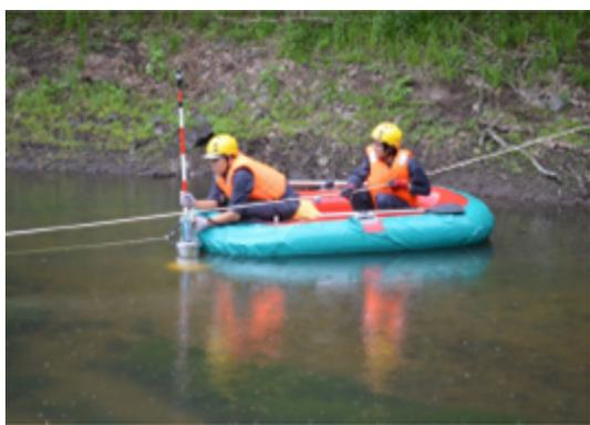
Fig. 1: 従来のため池の放射線量の計測作業 [4]
