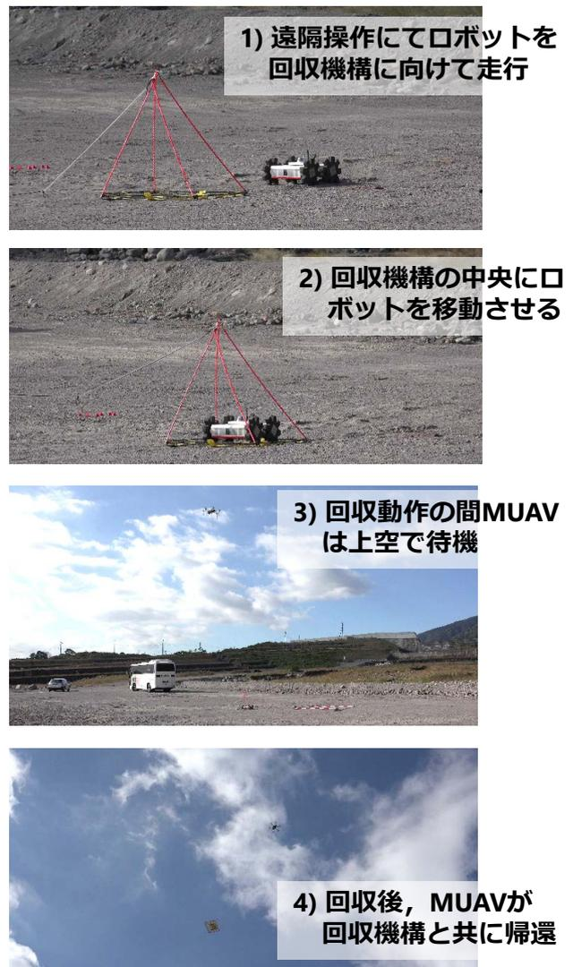
図5 雲仙普賢岳で実施した小型移動ロボットの回収動作の様子。
