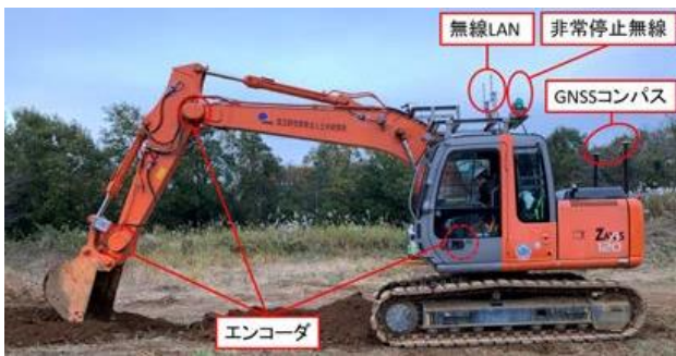
図5 標準プラットフォームを実装した油圧ショベル
