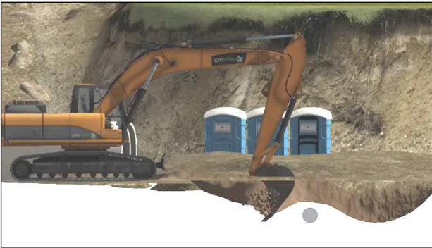
図2 シミュレータによる埋設管回避動作の確認
