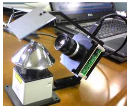
図1 測域センサと全方位視覚システムを組み合わせた色情報付き二次元距離情報取得システム
