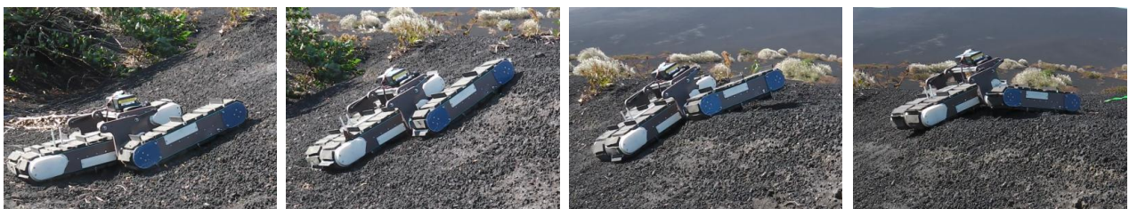
図 4 軟弱急斜面の走行
