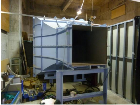
図5 開放式低速風洞(0.8m×0.8m)
