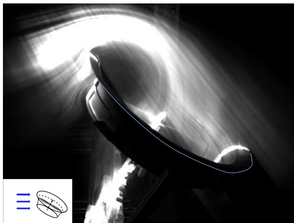
図9 シュラウド付きロータとオープンロータ周り流れ(迎角60, 90, 120[deg])
