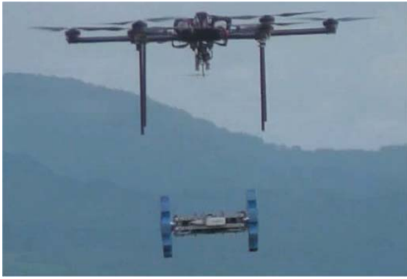
図8 テザーを用いた小型移動ロボットの運搬(浅間山)
