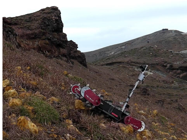
図 1 浮き石がある火山環境を走行するクローラ型移動ロボット
