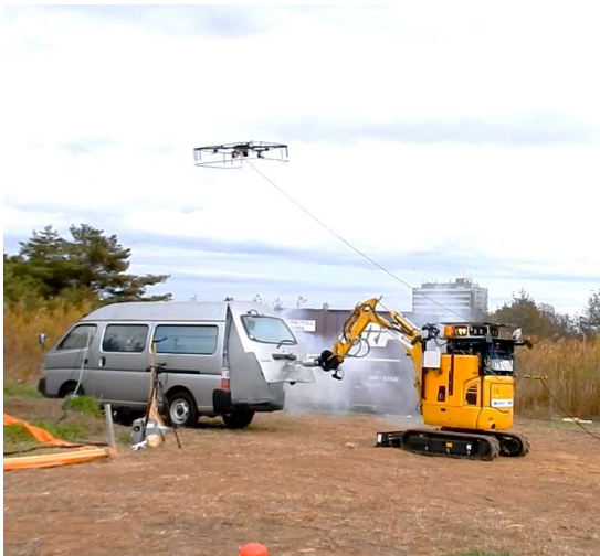
(a) 有線給電によりマルチロータ機が飛行している様子
