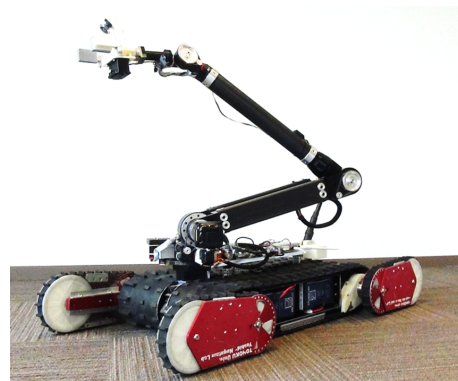
図 1: 小型マニピュレータを搭載した移動ロボット Quince
